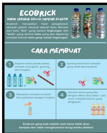
Gambar 1. Proses Pembuatan Ecobrick Dari Sampah Plastik
