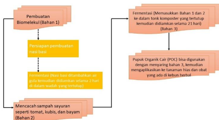
Gambar 2. Proses Pembuatan Pupuk Organik Cair (POC)
